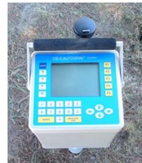
Relativgravimeter Scintrex CG-5
